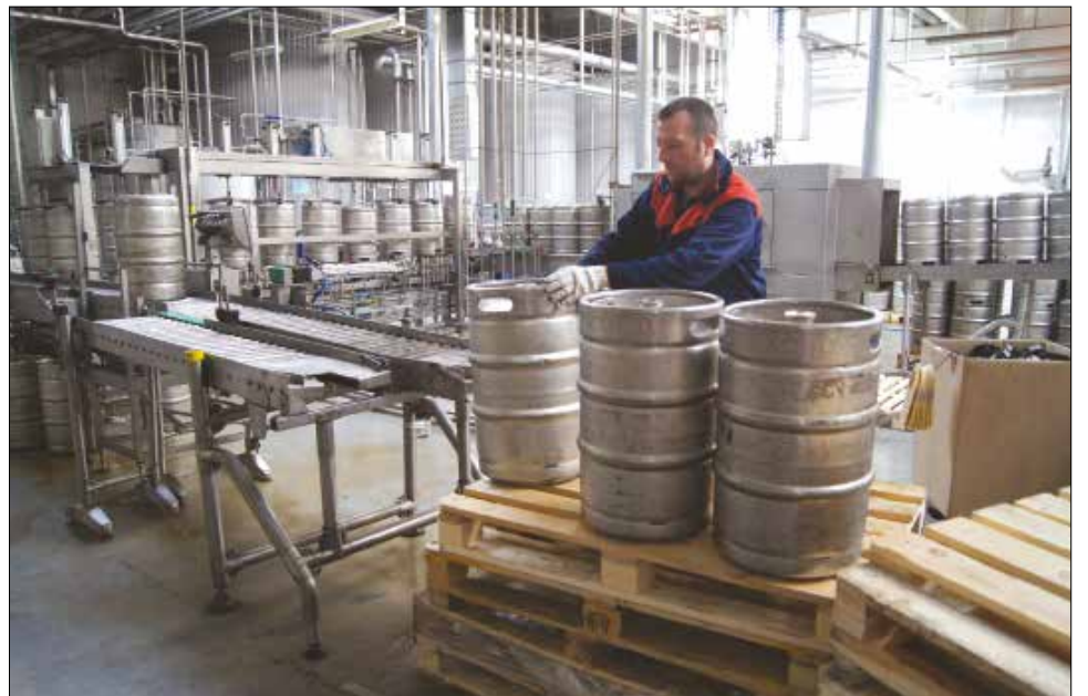
Перед «пивной заправкой» кеги тщательно промываются
